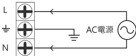
請依照交流電源標示，分別連接於引導燈具連動控制盤之交流電源輸入端，分別連接於L及N端，如上圖所示，電源之接地端，請連接圖示中的⏏端子點。
