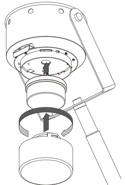
**7** 將測試棒罩住溫度探測器，以完成測試。
