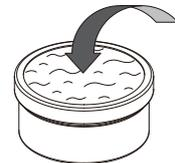
**4** 將燃料座置入測試棒底部，並裝上底座旋入固定。
